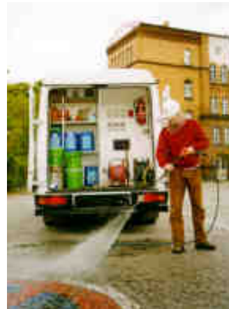
Hochdruckreiniger-Spülwagen: Alles dabei für die Graffiti-entfernung
