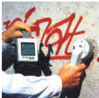
Messen der Farbwerte mit Spektralfotometer (Photo: Brillux)
