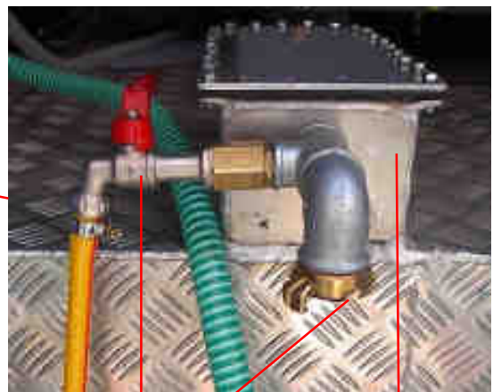
Gekaaanschluß mit Filter zur Befüllung des Wasseranschluß
