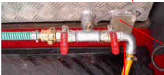
Kugelhahn zur Entleerung des Tanks und zur Wasserentnahme
